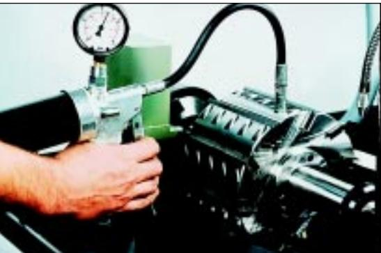
**Pistolet haute-pression à graisse avec manomètre pour utilisation dans la technique de serrage**
