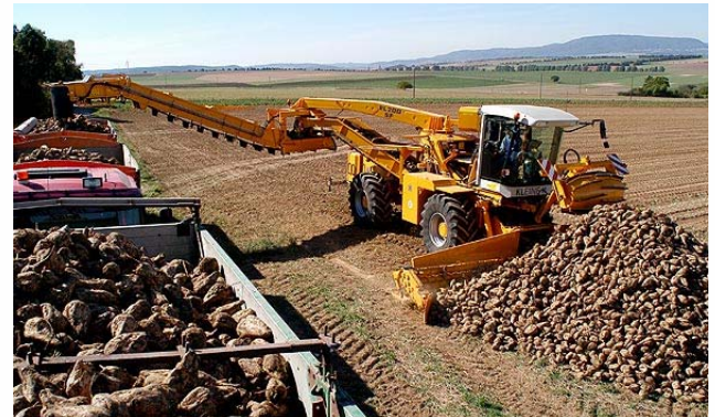
pulitrici e trasportatrici / cleaning and transfer machines
